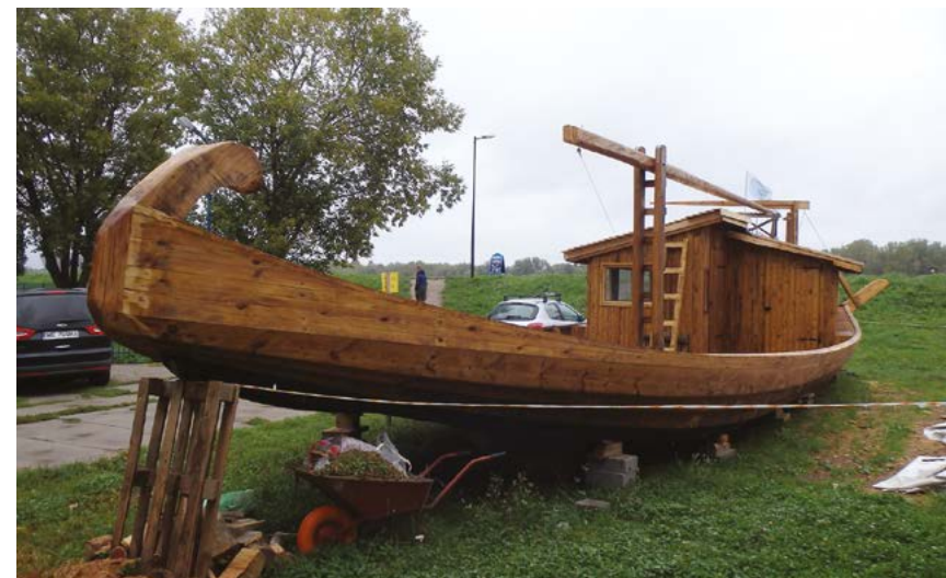
foto. 7. Pomniejszona replika szkuty wykonana wg rysunków Beneventusa von Losennau z 1796 r.– jednostka nosi nazwę Dar Mazowska (foto. A. Magnuszewski)
