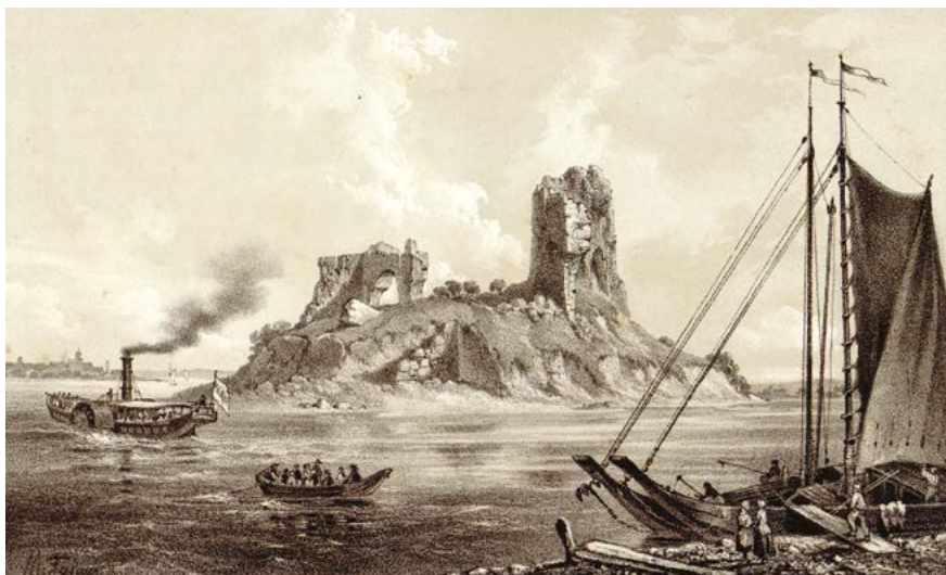
rys. 8. Przewodnik dla pasażerów żeglugi parowej wydany przez O. Flatta w 1845 r. – berlinki na Wiśle pod Bobrownikami, wysoka stewa dziobowa umożliwiała zamocowanie kotwicy i zblocza talii służącej do składania masztu 21
